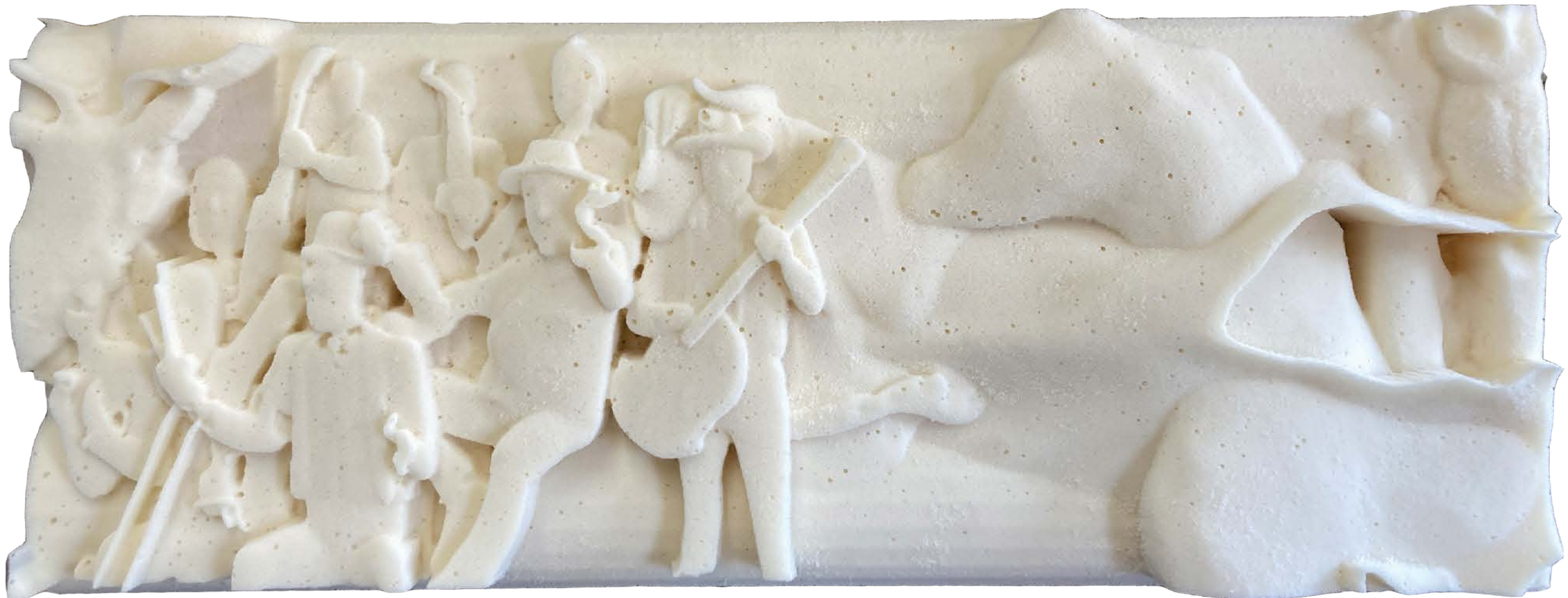
Eksempel på fysisk 3D-model som er CNC-fræst i skum og senere støbes i aluminium og autolakeres.
