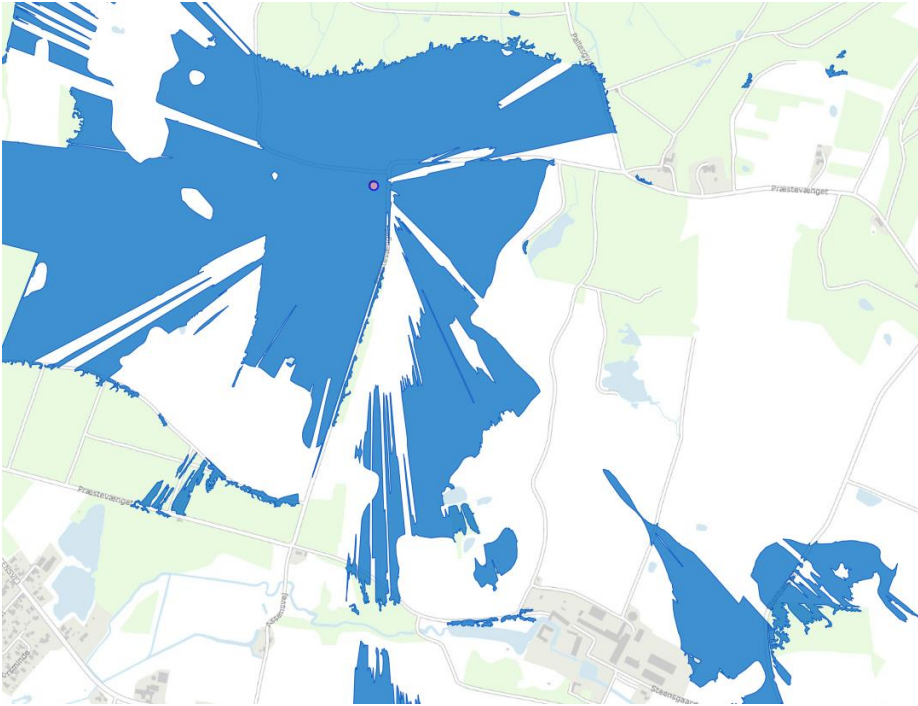
Figur 2.7: Synlighedsberegning for gyllebeholder. Elementhøjde er sat til 9 m (toppen af telt på gyllebeholder). Betragterhøjde er sat til 1,5 m.
