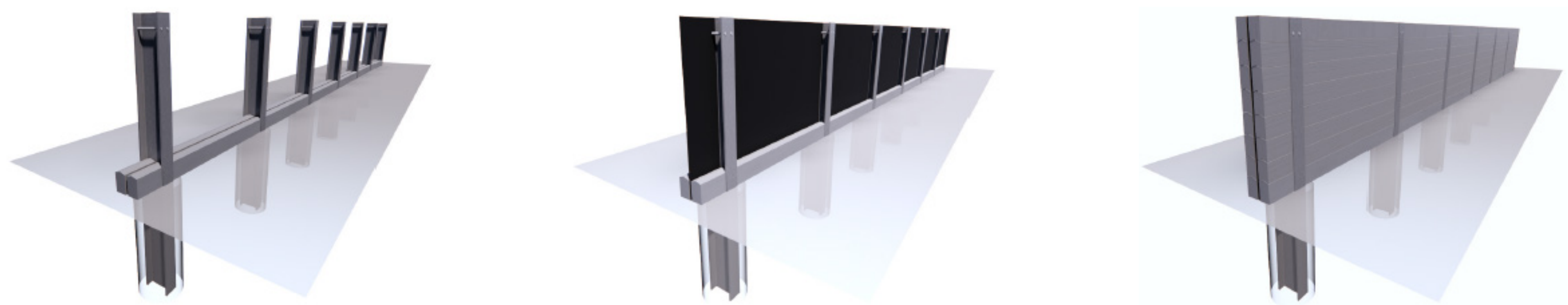
Sikringen opbygges på store dele af strækningen af H-profiler i stål, betonplanke i bunden og en vandtæt plade med egetræsplanker udenpå som passer ind i havnemiljøet
