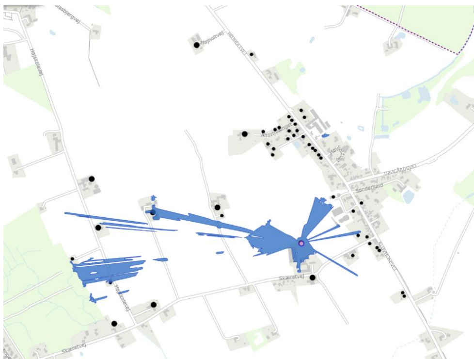
Figur 4: Synlighedsberegning for gyllebeholder uden teltoverdækning, med udgangspunkt i en højde på 2,6 m over terræn. Betragterhøjden er 1,5 m. Blå markering: Område hvorfra gyllebeholderen er synligt. Lyserød prik: Udgangspunktet for synlighedsberegningen. Store sorte prikker: Beboelsesejendomme med landbrugspligt indenfor 1 km radius. Små sorte prikker: Beboelsesejendomme uden landbrugspligt indenfor 1 km radius.
